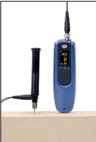
**Abbildung 5-1: Messung quer zur Faserrichtung mit M 20**
