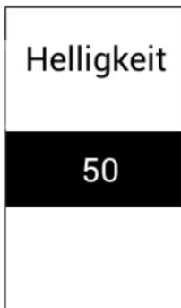
Die Helligkeit der Displayanzeige kann Stufenweise eingestellt werden. Es ist zu beachten, dass mit höherer Helligkeit die Stromaufnahme steigt und somit die Betriebszeit sinkt. In das Menü gelangt man wie folgt:
