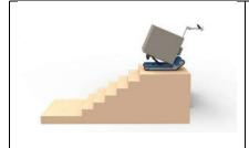
Vergewissern Sie sich, dass die Ware sicher befestigt ist, bewegen Sie den CT420C an die Treppenkante und lassen Sie zwei seitliche Raupen an der Kante der ersten Stufe anliegen. Schalten Sie den automatischen Ladetafel-Modus mit dem Handheld-Controller ein, und stellen Sie die Geschwindigkeit auf 1 ein.
