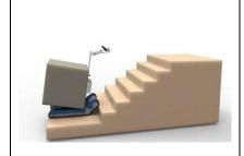
Vergewissern Sie sich, dass die Güter sicher befestigt sind, fahren Sie CT420C an den Rand der Treppe und stellen Sie sicher, dass die beiden Raupen an der Kante der ersten Stufe anliegen. Schalten Sie den Automatikmodus des Ladeplattform auf der Handsteuerung ein, stellen Sie die Geschwindigkeit auf Stufe 1 ein und fahren Sie die Treppe mit den Raupen hinauf.
