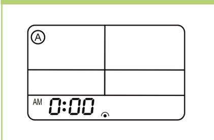
Nach Betätigung der tiefer liegenden Taste C mittels eines kleinen Stiftes o. ä., blinkt die Anzeige der Uhrzeit. Durch Halten der Taste TIME-SET wird anfänglich langsam und dann immer schneller die angezeigte Uhrzeit verstellt. Nach erfolgter Einstellung wird die Taste C erneut gedrückt um die Uhrzeit zu speichern. Die Anzeige blinkt nicht mehr.
