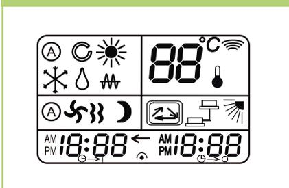
Nach Betätigung der tiefer liegenden Taste R mittels eines kleinen Stiftes o. ä., werden alle Symbole auf dem Display dargestellt. Nach ca. 5 Sekunden blinkt nur noch die Anzeige der Uhrzeit. Nach Betätigung der tiefer liegenden Taste C muss durch anschließendes Halten der Taste TIME-SET die Uhrzeit eingestellt werden. Nach erfolgter Einstellung wird die Taste C erneut gedrückt um die Uhrzeit zu speichern. Die Anzeige blinkt nicht mehr.
