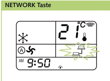
Die Taste NETWORK ermöglicht die Übermittlung der programmierten Einstellungen des Master-Gerätes (Führungsgerätes) an alle im Netzwerk befindlichen Slave-Geräte (Folgegeräte).
