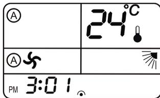
Betätigen Sie ein- bzw. mehrmals die Taste MODE um in den Automatikmodus zu wechseln. In diesem Modus wählt die Regelung, abhängig von der Temperatur, selbstständig den COOL oder HEAT Modus und hält den eingestellten Temperaturwert konstant. Vorausgesetzt es steht genügend Kühl- bzw. Heizmedium mit ausreichender Temperatur zur Verfügung. Die FAN Einstellung sollte auf AUTO eingestellt werden.
