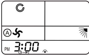
Betätigen Sie ein- bzw. mehrmals die Taste MODE um in den Umluftmodus zu wechseln. In diesem Modus wird das Gerät als Umluftgerät genutzt. Es wird keine Kühl- oder Heizleistung an den Raum abgegeben.
