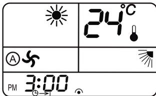
Betätigen Sie ein- bzw. mehrmals die Taste MODE um in den Heizmodus zu wechseln. Nutzen Sie diesen Modus um die Raumluft auf die gewünschte Solltemperatur zu erwärmen. Voraussetzung hierfür ist ein entsprechendes Vorhandensein an Wärme in der Kaltwasseranlage.
