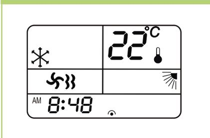
Die Taste TEMP ermöglicht die Einstellung der gewünschten Solltemperatur in 1 °C Schritten. Im Umluftmodus FAN ist diese Einstellung nicht möglich.
