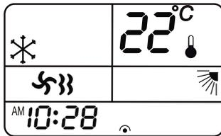
Nach Betätigung der Taste „FAN“ wird in der Anzeige die Ventilatorgeschwindigkeit „AUTO“ sichtbar. Jede weitere Betätigung der Taste führt zu einer hohen (H), mittleren (M) und niedrigen (L) Einstellung der Geschwindigkeit.
