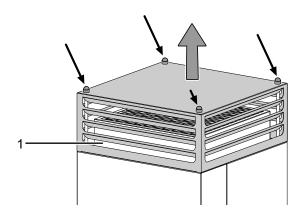
4. Entnehmen Sie den H14-HEPA-Filter aus dem Gerät.
