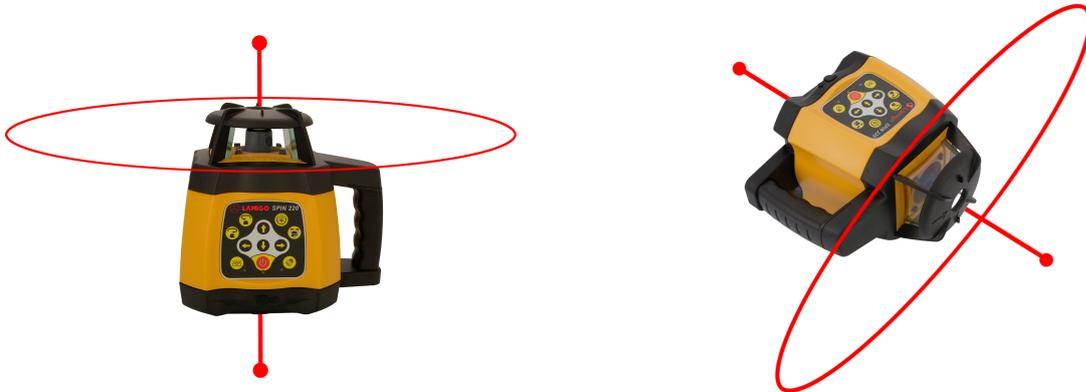
Wird das Gerät aufrecht aufgestellt, sendet es eine horizontale Rotationsebene und zwei vertikale Lotstrahlen aus. Wird der Laser mit dem Bedienfeld nach oben aufgestellt, wird eine vertikale Rotationsebene und zwei horizontale Lotstrahlen emittiert.
