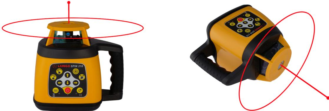
Wird das Gerät aufrecht aufgestellt, sendet es eine horizontale Rotationsebene und einen vertikalen Lotstrahl aus. Wird der Laser mit dem Bedienfeld nach oben aufgestellt, wird eine vertikale Rotationsebene und ein horizontaler Lotstrahl emittiert.
