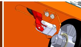
Parkbremse für einen sicheren Stand der Maschine
