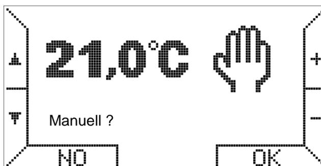
Drücken Sie die +/- Tasten um die Temperatur zu verändern und danach die OK-Taste um den manuellen Modus zu aktivieren.
