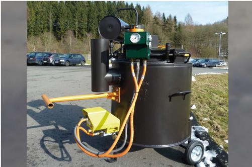
Zum Aufschmelzen von temperaturempfindlichen Vergussmassen und thermoplastischen Massen
