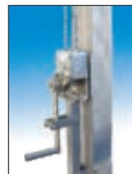
Die Betriebshöhe wird durch die Kettenwinde mit Kurbel erreicht. Hier rastet eine Sperrfalle ein und sichert den Aufbau. Die Handkurbel verfügt über eine Rücklauf (-schlag) -Sicherung und ist im Betrieb des Geräts durch eine Kurbelsicherung gesperrt.
