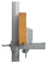
Einfachverklebung der Richtlatten. Es können auch zwei Richtlatten mit 5 cm Stärke in die Schiebリングe eingespannt werden.
