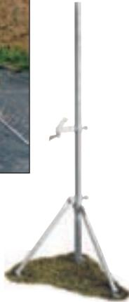
Bestehend aus einem Rohr 48 mm Ø, 2,00 m lang, mit einem angeschweißten Erdnagel und zwei beweglichen Befestigungsstreben mit Erdnägeln. Mit einem Schiebリング zur Aufnahme von Richtlatten. Für die Ecke werden zwei Schiebリングe zur Aufnahme von Richtlatten geliefert.
