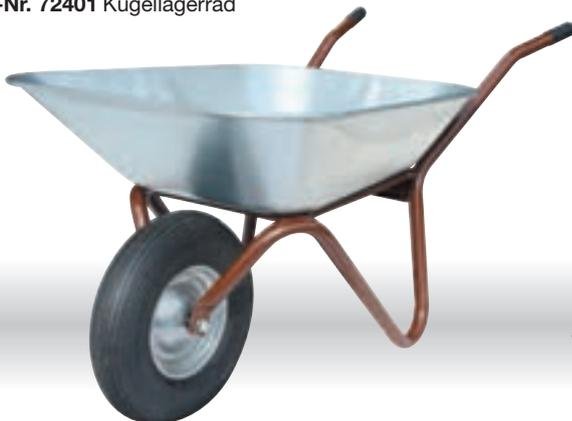
mit nahtlos gezogener verzinkter Mulde, 85 Liter Inhalt, Muldenrand mit ganzer Rundeiseneinlage verstärkt, Rad mit Luftbereifung 400 x 100 mm Muldenstärke: 1,05 mm, Stahlfelge
