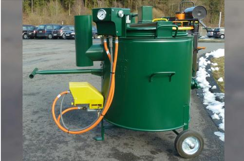
Zum Aufschmelzen von bitumösen und thermoplastischen Massen.
