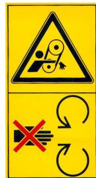
Bei laufendem Motor niemals Schutzeinrichtungen öffnen oder entfernen.
