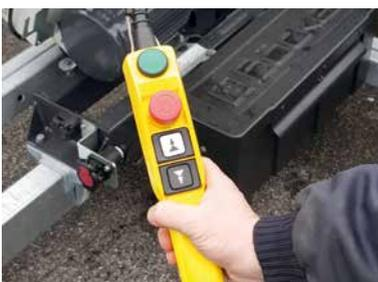
Elektrische Steuerung mit Schleichgang (optional)
