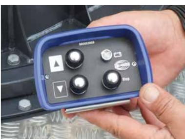
Optionale Bedienung unten über Funksteuerung
