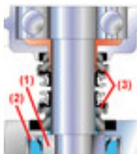
Alle Tsurumi-Pumpen verfügen über ein 2-faches Dichtungssystem für längere Standzeiten:
