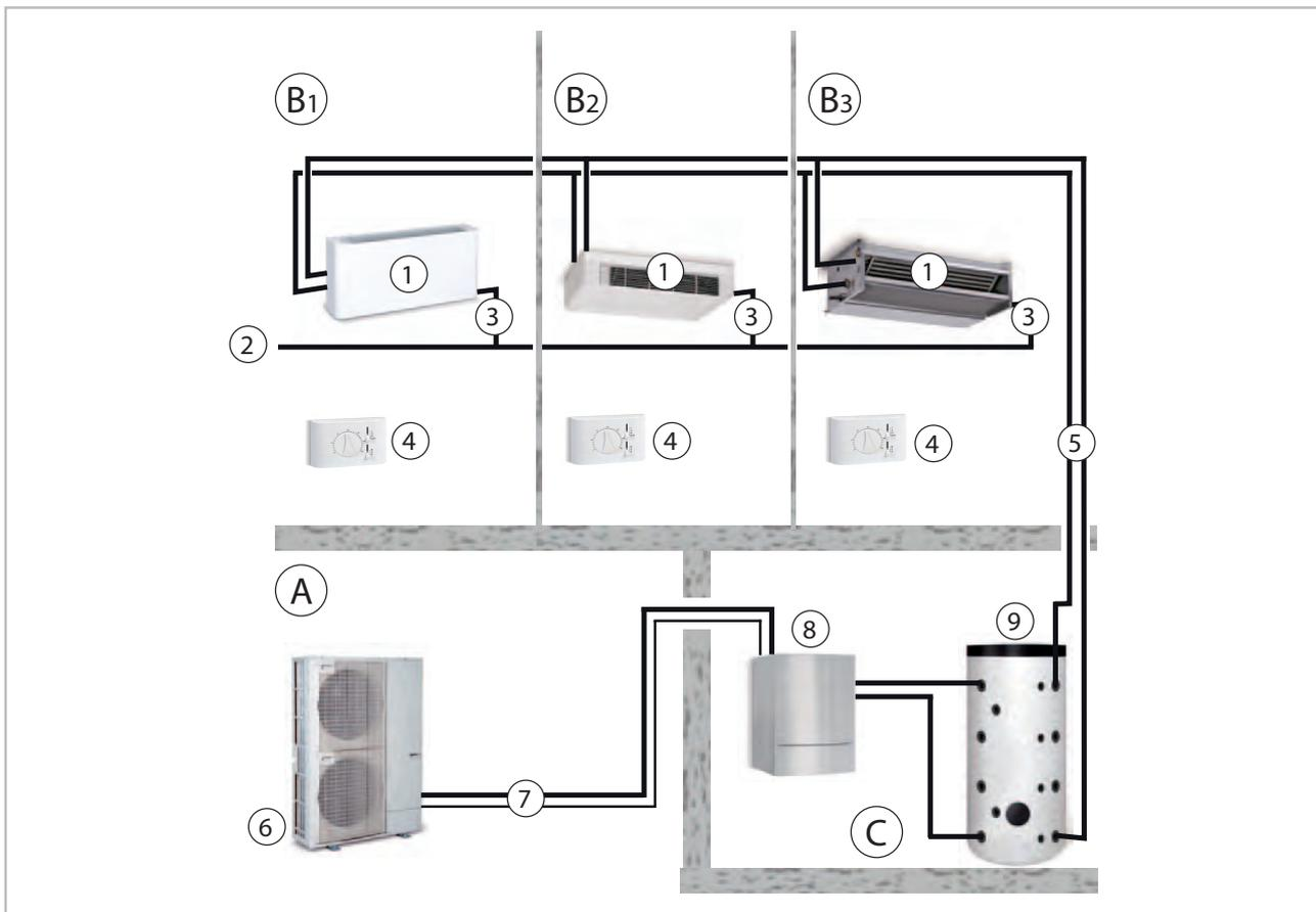
Abb. 5: Beispiel Systemaufbau 2-Leiter-System (Wärmepumpen-System)
