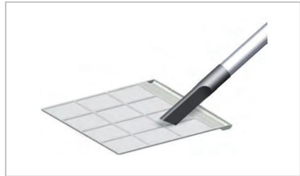
Abb. 19: Reinigung mit dem Staubsauger
