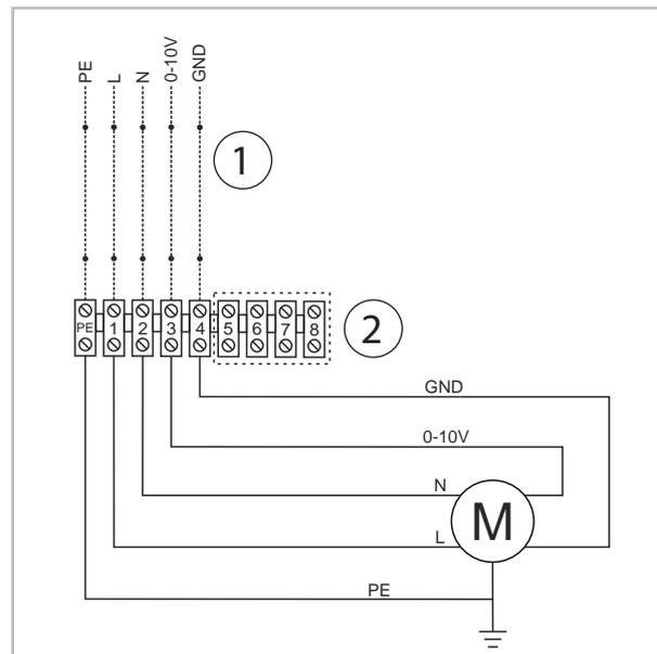
Abb. 17: Elektrisches Schaltschema
