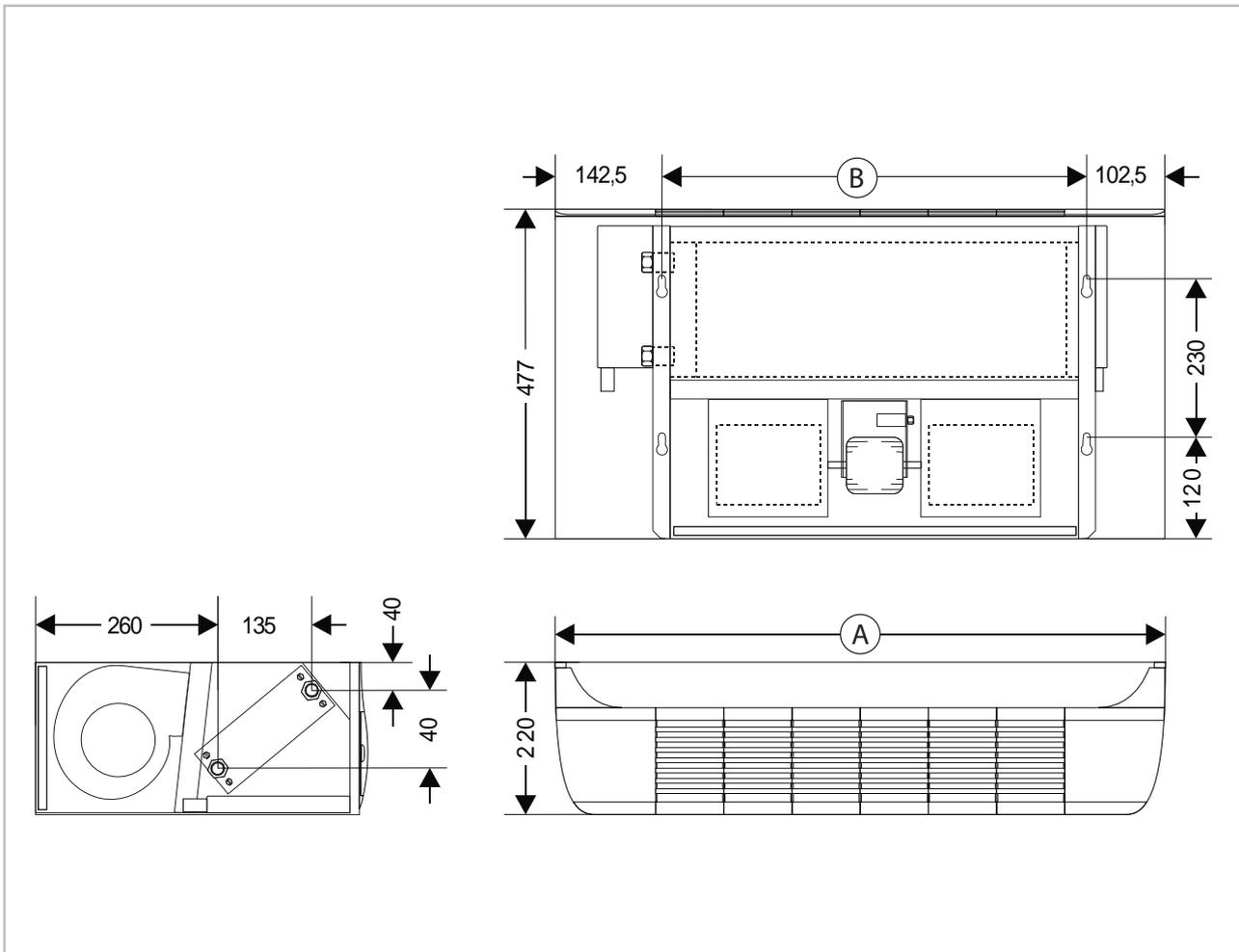
Abb. 2: Geräteabmessungen (alle Angaben in mm)
