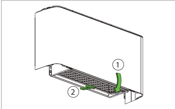
Abb. 18: Filterentnahme
