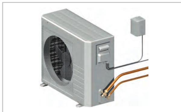
Abb. 37: Anschluss des Außenteils
