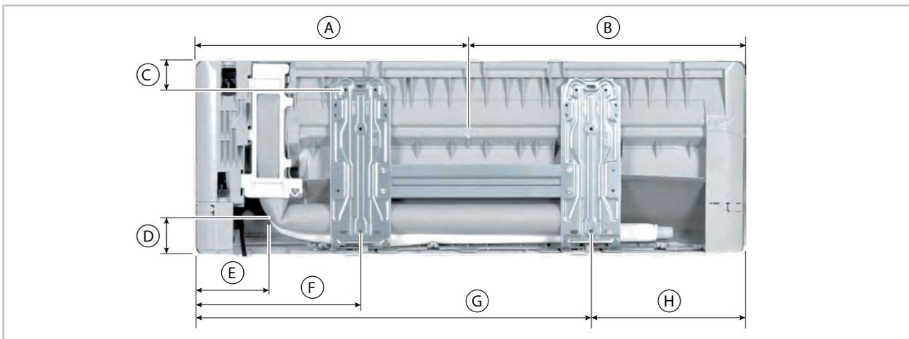
Abb. 25: Montagepunkte der Wandhalterung SKW 261-521 DC (Rückansicht, alle Maße in mm)
