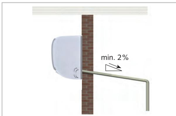
Abb. 35: Kondensatanschluss Innengerät
