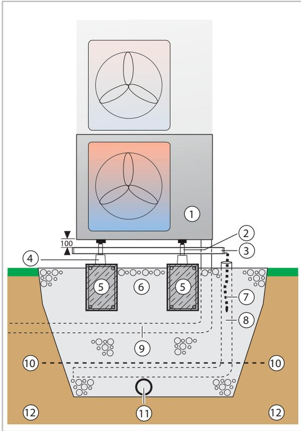
Abb. 33: Kondensatableitung, Versickerung von Kondensat und Streifenfundament (Schnitt)
