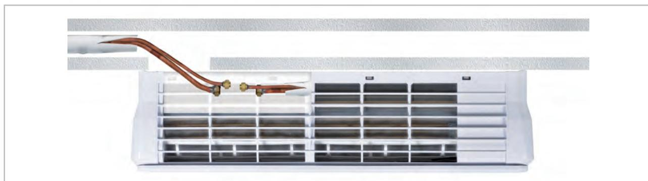
Abb. 27: Unterputzinstallation der Kältemittelleitungen (Ansicht von oben)
