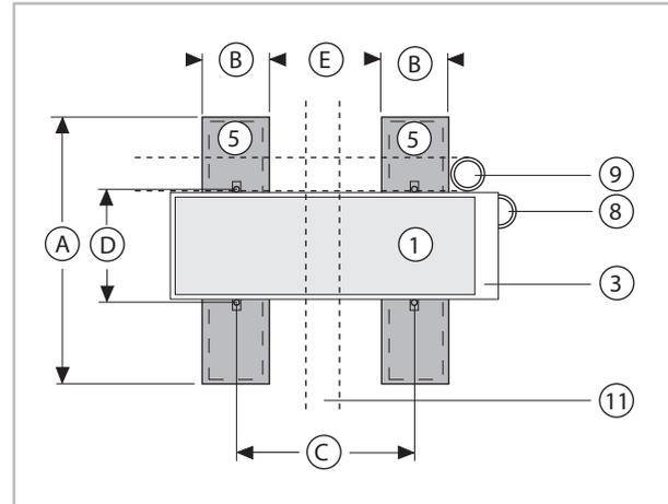
Abb. 34: Bemaßung des Streifenfundaments (Draufsicht)
