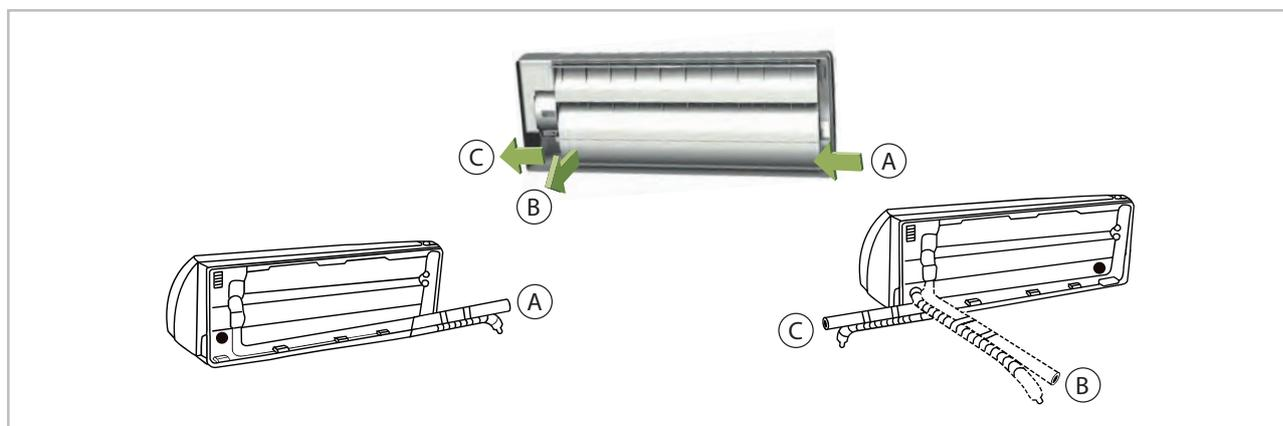
Abb. 26: Anschlussvarianten (Ansicht von hinten)
