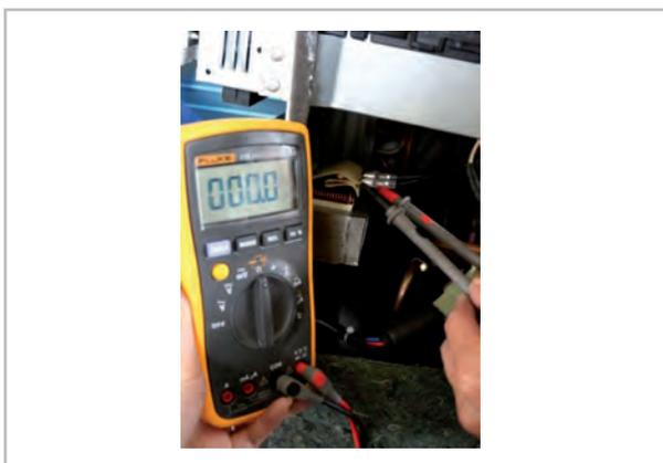
Prüfen Sie den Transformator (dieser darf nicht mit einem Kondensator verbunden sein) mit einem Multimeter. Der Normalwert liegt bei ca. 0 Ohm. Sollte der Wert abweichen, tauschen Sie den Transformator aus.
