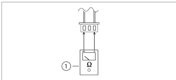
Abb. 44: Temperatursensoren prüfen
