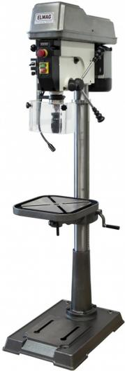
1 Stk. Keilriemen-Säulenbohrmaschine
