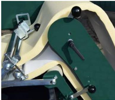
Neue Schwammbandtechnologie mit neuer Schaumstoffart für die Aufnahme von bis zu 4 mm großen Sandkörnern. Das Schwammband wird auf einem Transportband befördert und kann sich dadurch nicht dehnen und seitlich laufen, was eine lange Lebensdauer bewirkt.
