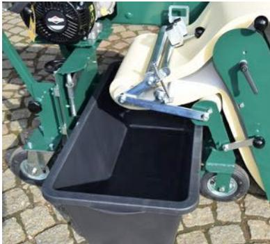
Ein hochklappen der Auspresseinheit ermöglicht ein einfaches und schnelles Wechseln des Wasserbehälters.
