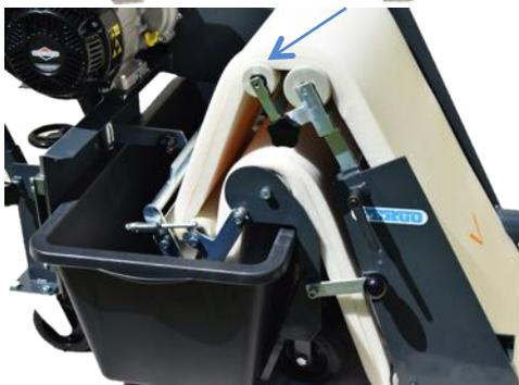
Die Schwammspannung und der Lauf des Schwammbandes wird durch die Toprollen eingestellt. Durch 3 Rollen wird das Schwammband angetrieben.
