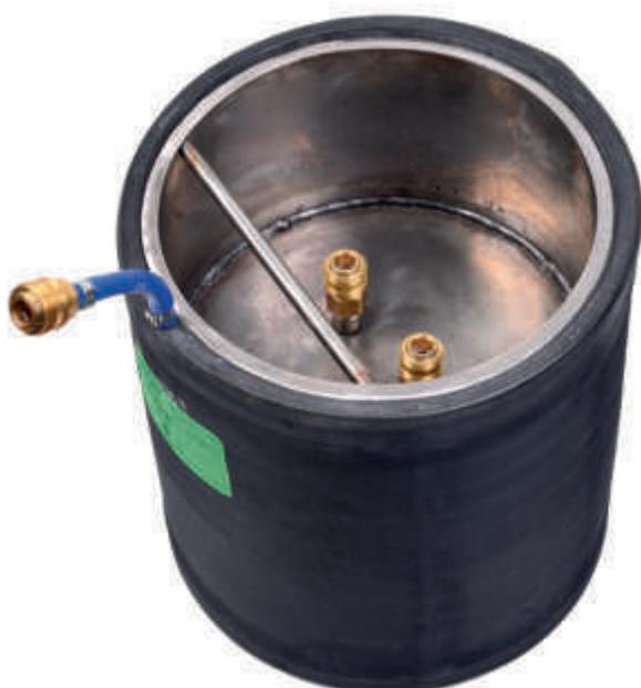
Diese Prüf-Dichtkissen eignen sich für Dichtheitsprüfungen von Standard-Schächten mit Wasser oder Luft nach DIN EN 1610. Prüfdruck ist 0,001 MPa (100 mm Wassersäule).
