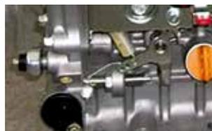
Ölüberwachung zur Abschaltung bei niedrigem Öldruck
