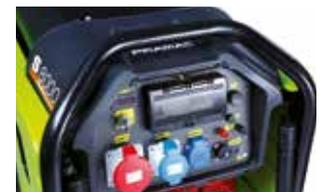
Digitale Multifunktionsanzeige (Betriebsstundenzähler, Spannung und Frequenz)
