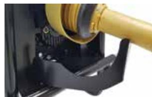
Klappbare Gelenkwellenablage für sichere Zapfwellenverbindung
