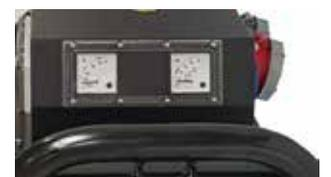
Von der Zugmaschine ablesbare analoge Instrumente
