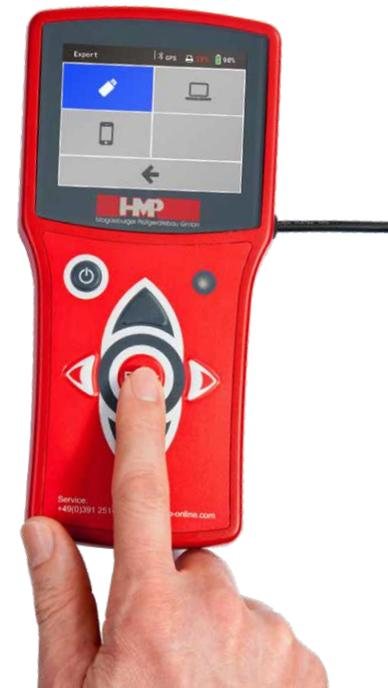
Dynamischer Plattendruckversuch nach TP BF-StB Teil B 8.3
