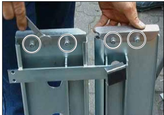
**Bild 5.15 M8-Befestigungsmuttern des Endanschlages**
