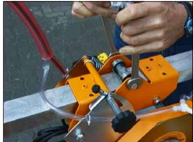
**Bild 5.8** Halteschraube der Lager lösen
