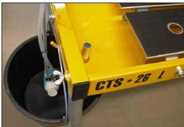
Bild 3.17 Tauchpumpe im Wassereimer, Überlaufrohr gesteckt
