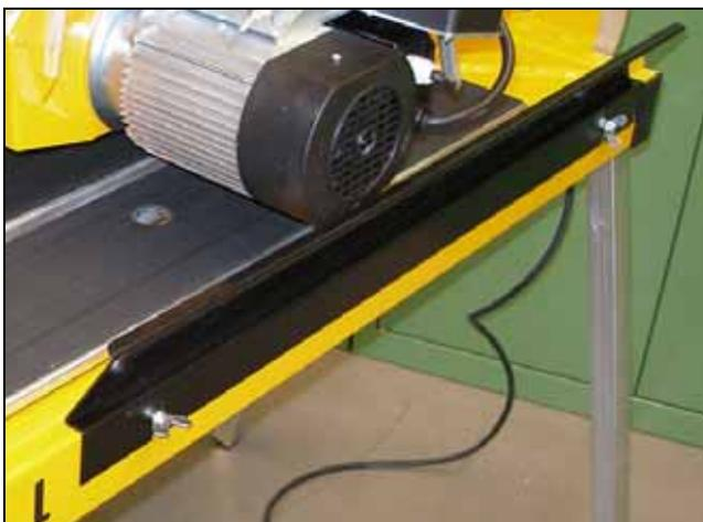
Bild 3.6 Seitlicher Spritzschutz montiert
