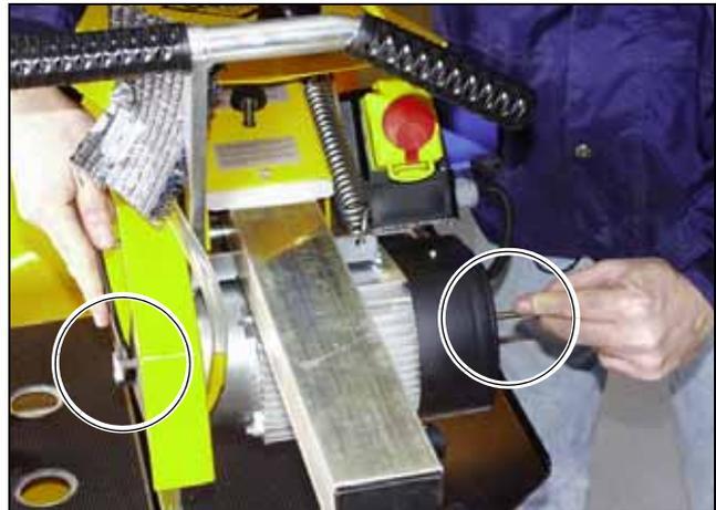
Bild 3.22 Lösen der Schneidwellenmutter durch Gegenhalten der Schneidwelle
