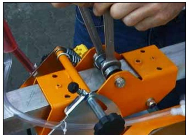
**Bild 5.9** Exzenter verdrehen
