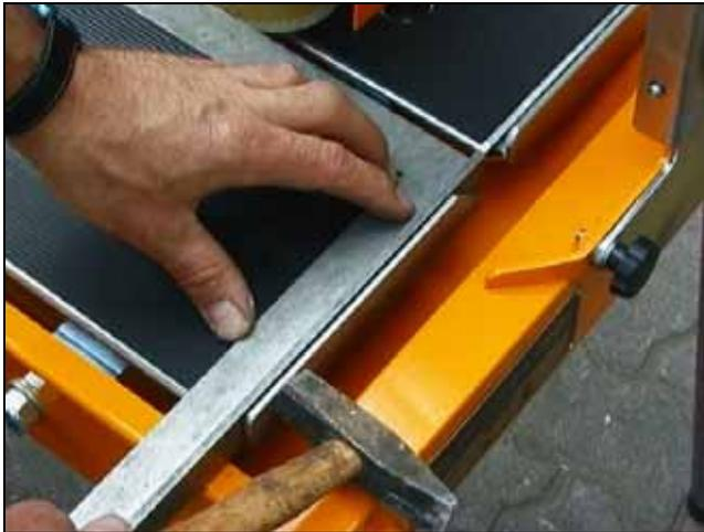
**Bild 5.17** Werkstisch-Endanschlag ausrichten
