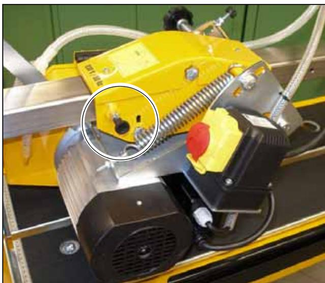
**Bild 3.10** Rastbolzen am Führungsschlitten
