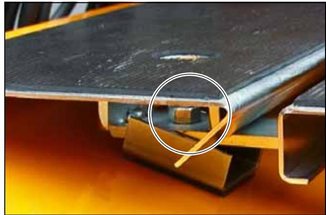
**Bild 5.23** Einstellschraube eines Einlegetischfußes
