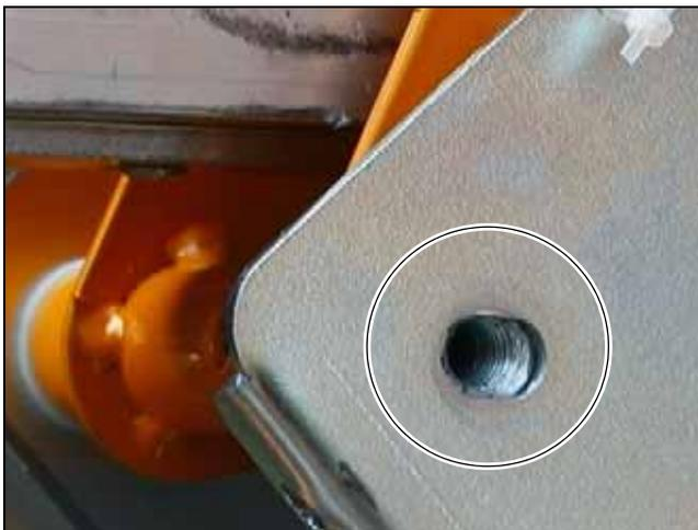
**Bild 5.10** Langloch am Tiefschwenklager (zur besseren Darstellung Schraube entfernt)
