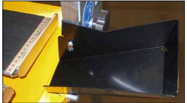
Bild 3.7 Vorderen Spritzschutz eingehängt
