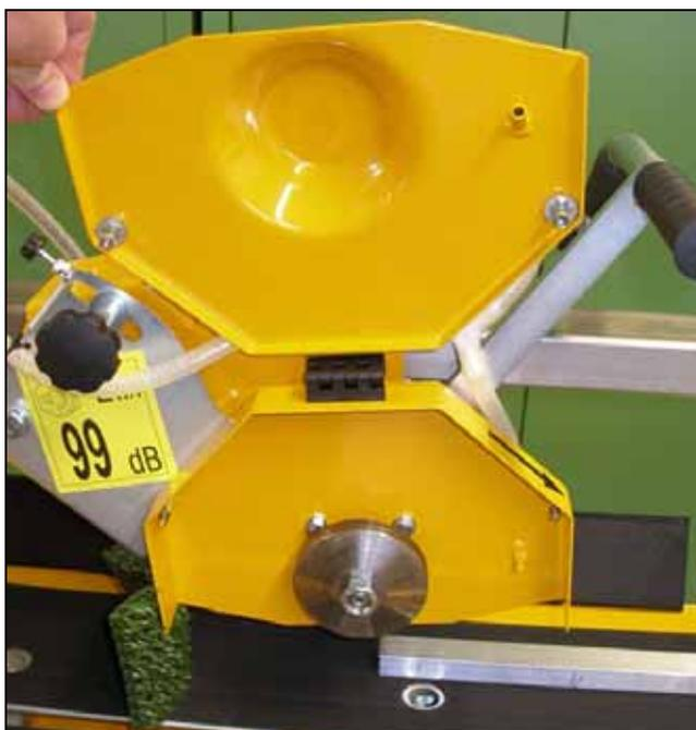
Bild 3.21 Blattschutzdeckel aufgeklappt
