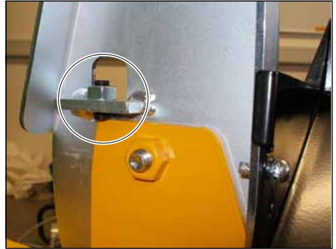
**Bild 5.19** 90°-Anschlag der Schrägschnitteinstellung
