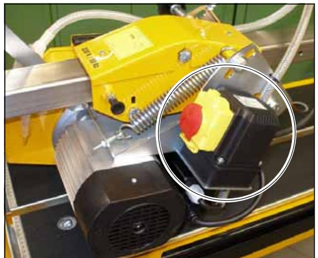
Bild 3.15 Hauptschalter mit Not-AUS-Taster
