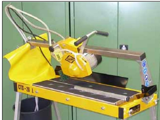
Bild 3.28 Führungsschiene für Gehrungsschnitt geschwenkt
