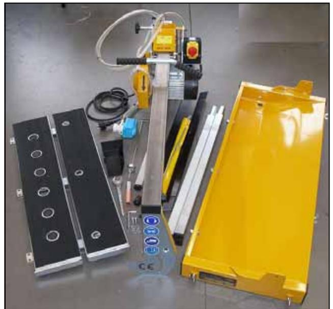
Bild 1.3 CTS•26 L für den Transport zerlegt
