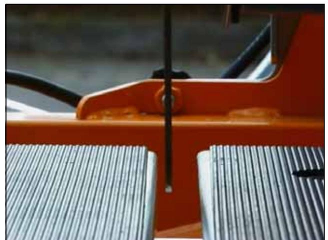
**Bild 5.20** Korrekte Mittenstellung des Blattes
