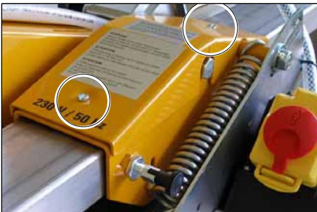
**Bild 5.7** 2 Befestigungsschrauben am Führungsschlitten-Deckelblech
