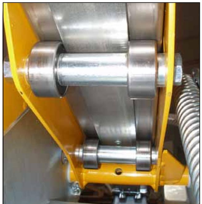
Bild 5.6 „Saubere“ Führungsschiene und Pendelschneidkopflager (Unterseite)
