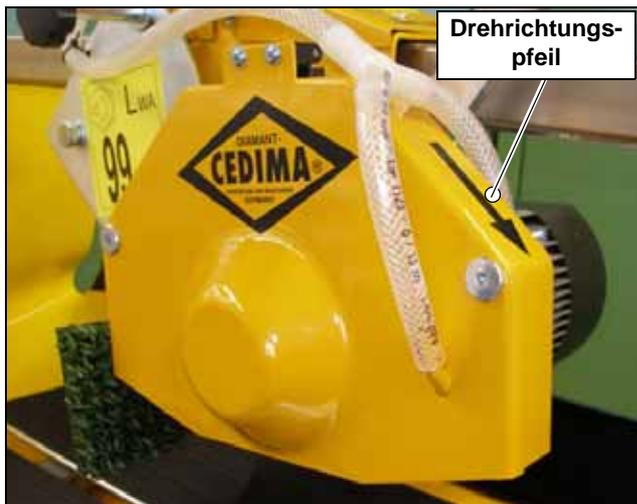
Bild 3.24 Drehrichtungspfeil auf dem Blattschutz
