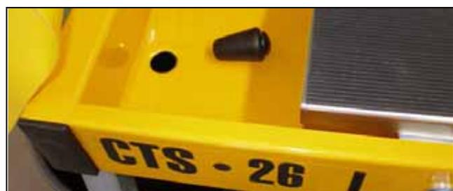
Bild 3.19 Wasserablaßloch in der Wasserwanne (mit Stopfen)
