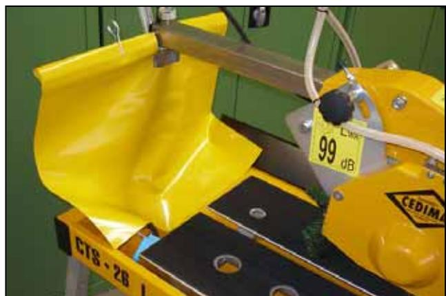
**Bild 3.13** Spritzschutzplane montiert
