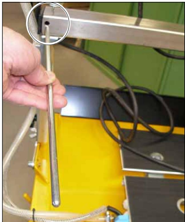
**Bild 3.12** Stange für die Spritzschutzplane
