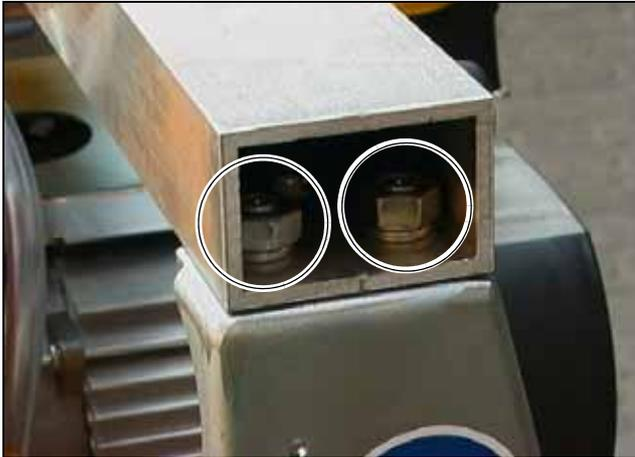
**Bild 5.21** Befestigungsschrauben der Führungsschiene (nach Entfernen der Gummikappe)
