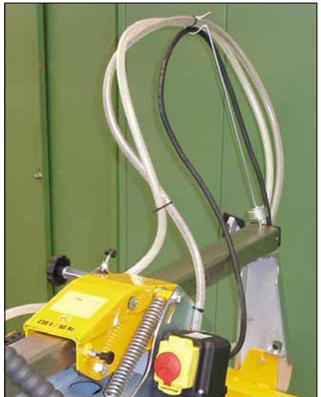
Bild 3.8 Kabel-Schlauchhalter eingesteckt, Kabel und Wasserschlauch eingehängt
