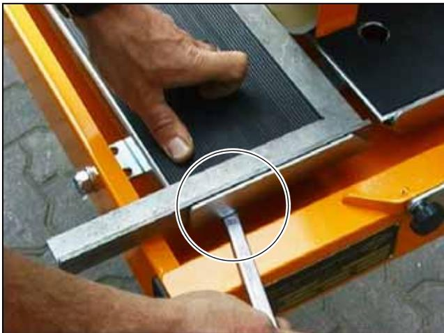
**Bild 5.18** M8-Muttern/Schrauben des Endanlasses festziehen
