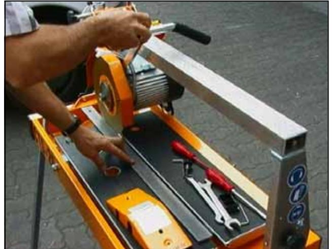
**Bild 5.11** Lineal oder Flachstahl anlegen
