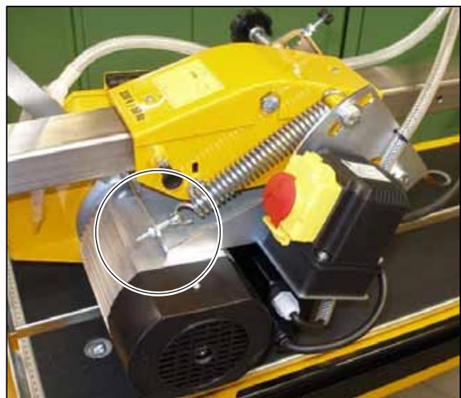
**Bild. 5.24** Einstellmöglichkeit der Pendelschneidkopf-Ausgleichfeder
