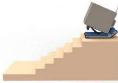
Fahren Sie den Treppensteiger CT310 an den Rand der Plattform auf der Treppe. Schalten Sie den CT310 mit dem Betriebsartenschalter in den Automatikbetrieb und fahren Sie mit der Raupe die Treppe hinunter.
