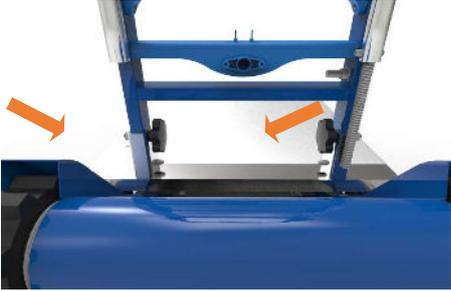
A close-up view of the back of the CT310 machine. Two orange arrows point to the top of the machine's frame, indicating where to secure it with a turn knob.        | <p>Sichern Sie die Rückwand des CT310 mit dem Drehknopf.</p> <p>Und stecken Sie den Kabelstecker des mit Federdraht in die entsprechende Buchse.</p> <ul style="list-style-type: none"><li>•</li><li>•</li></ul> |
