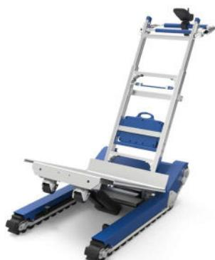
Der CT310 kann auf ebenem Boden mit Raupenfahrwerken laufen. Schalten Sie in den Laderaumsteuerungsmodus, heben Sie den Laderaum in einem Winkel an, bis die Raupenkette den Boden berühren, und schalten Sie dann in den Raupenmodus und gehen Sie mit den Raupenkette.
