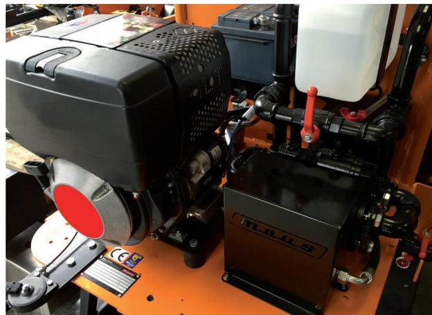
Die beheizte MAUS® Spezial-Kaltbindemittel-Pumpe wird mit einem 5,9 KW HONDA-Benzinmotor hydraulisch angetrieben.
