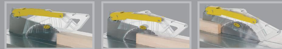
Durch eine Einlaufschräge hebt sich die Schutzhaube durch das zu sägende Material vorne an und legt sich dann waagrecht auf das Holz. Nach dem Schnitt senkt sich die Schutzhaube wieder auf den Maschinentisch ab.
