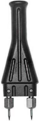
für Oberflächen- und Tiefenmessungen bis zu ca. 50 mm an Schnittholz, Furnieren, sowie Spanplatten und Faserplatten und zur Messung von weichen abgebundenen Baustoffen (z. B. Gipsputz etc.), bis ca. 70 mm Tiefe,
