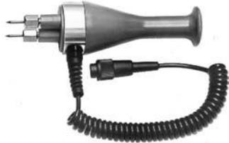
Aktive Sonde mit integrierter Elektronik für die Erfassung hoher Holzfeuchtwerte in Nadelholz, speziell bei der Nasslagerung und zur Vorsortierung frischer Schnittware bei der künstlichen Holz Trocknung.
