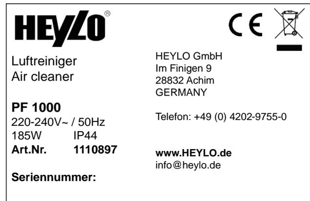
Auf dem Typenschild sind folgende Angaben zum Gerät angebracht:
