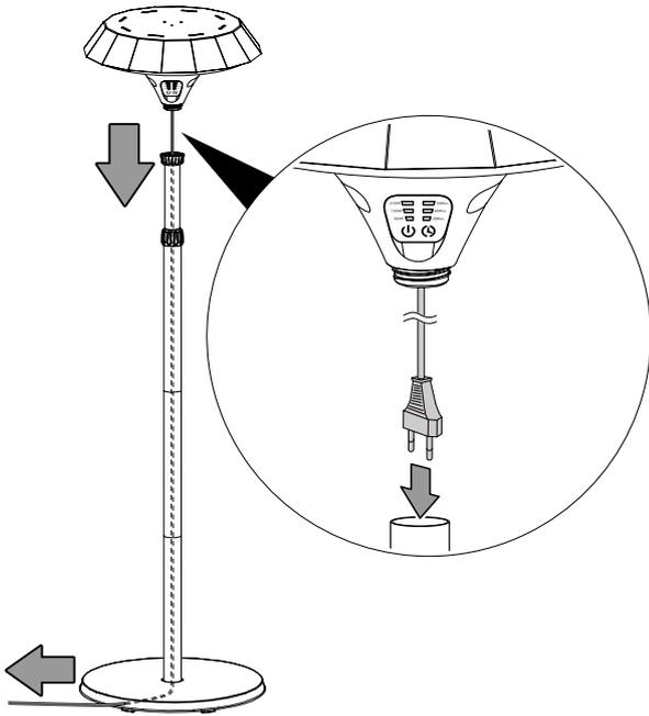
5. Setzen Sie den Heizstrahler auf das Rohr und drehen Sie den Heizstrahler im Uhrzeigersinn fest.
