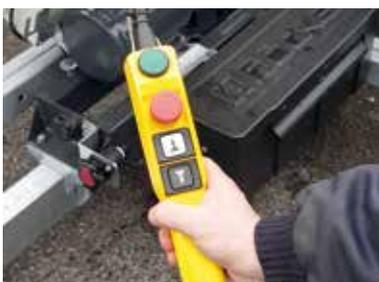
Elektrische Steuerung mit Schleichgang (optional)
