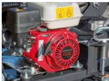
Antrieb über leistungsstarken Benzin- oder E-Motor
