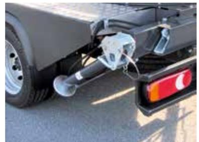
Hydraulische Stützen mechanisch ausziehbar und 60° schwenkbar
