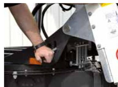
Verstellbarer Drehkranz mit mechanisch lösbarer Sperre
