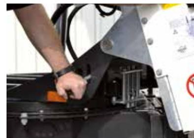
Verstellbarer Drehkranz mit mechanisch lösbarer Sperre
