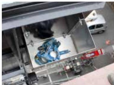
Pritsche ist mit Ablagefächern für Kleinteile ausgestattet
