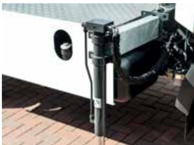
Hydraulische Stützen vorne optional ausziehbar
