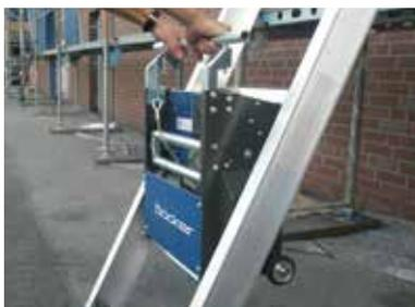
Einfaches Einhängen der Antriebseinheit
