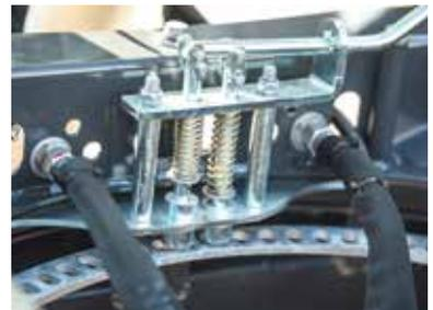
Stufenlos verstellbarer Drehkranz mit mechanisch lösbarer Sperre
