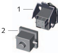
2. Den Stecker [3] des Raumthermostaten [4] mit der Thermostatsteckdose [1] des Gerätes verbinden.
