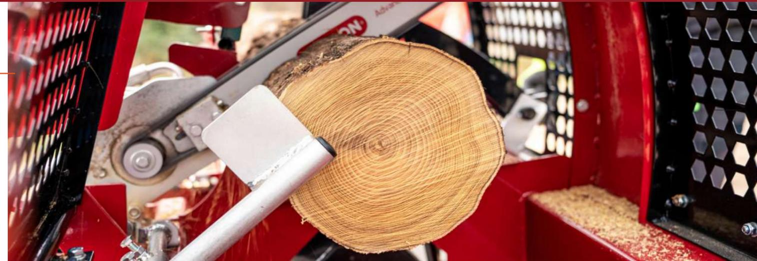
Die Kettensäge wird von Hand über einen gut erreichbaren Bügel abgesenkt. Bei Absenkung des Bügels schaltet sich die hydraulisch angetriebene Kettensäge automatisch ein. Die Bedienung erfordert **wenig Kraftaufwand**. Sobald der Stamm abgesägt wurde wird der Spaltvorgang automatisch ausgeführt. Nach Beendigung des Spaltvorgangs fährt der Spaltzylinder wieder automatisch in die Ausgangsstellung zurück.
