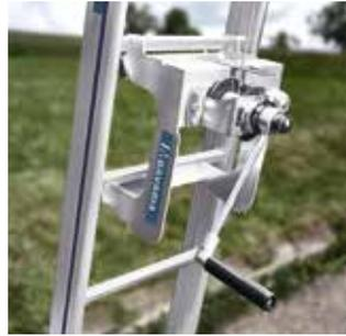
Durch die Seilwinde mit Sicherheitsbremse wird der Schlitten mit wenig Kraftaufwand nach oben gezogen.
