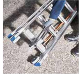
Die Umlenkrolle wird am Boden auf die Leitern gesteckt und das Seil wird eingefädelt. Ein Besteigen der Stützleitern ist nicht nötig.
