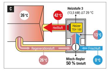
**Beispiel C** zeigt einen 50-%-Mischbetrieb aus Außenluft und Regenerationsluft. Selbst bei einer Reduzierung auf Heizstufe 3 (13,5 kW) lässt sich das Zelt durch die hälftige Nutzung mit bereits erwärmter Regenerationsluft höher erwärmen als im Beispiel A mit reiner Frischluft – dies entspricht einer Energieersparnis von 33 %.
