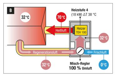
Im Beispiel B steht der Misch-Regler auf 100 % Umluft – es wird ausschließlich Regenerationsluft zur Beheizung genutzt. Weil nun bereits erwärmte Luft für die Warmlufterzeugung verwendet wird, ist die nutzbare Heizleistung deutlich höher. Nach Erreichen der Zieltemperatur kann deshalb die höchste Heizstufe des Gerätes also um ein bis zwei Stufen und damit um bis zu 66% reduziert werden.
