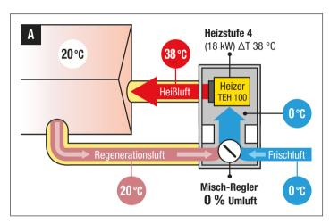
**Beispiel A** zeigt ein 'klassisches' Beheizungsszenario. Der Misch-Regler steht auf 0 % Umluft, es wird also ausschließlich Außenluft zur Beheizung genutzt, deren Temperatur 0 °C beträgt. Das eingesetzte Elektroheizgerät erzeugt auf maximaler Heizstufe 4 (18 kW) 38 °C heiße Luft, die das Zelt auf ca. 20 °C aufheizt.
