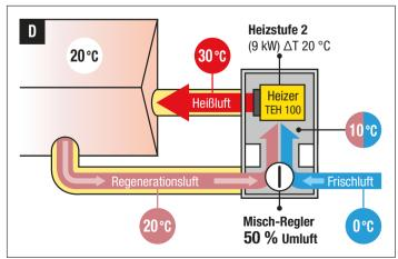
**Beispiel D** demonstriert einen 50-%-Mischbetrieb, der auf Heizstufe 2 (9 kW) noch immer annähernd das gleiche Beheizungsergebnis erzielt wie im Beispiel A die volle Heizstufe mit 100 % Frischluft, was einer Energieersparnis von 66 % entspricht.
