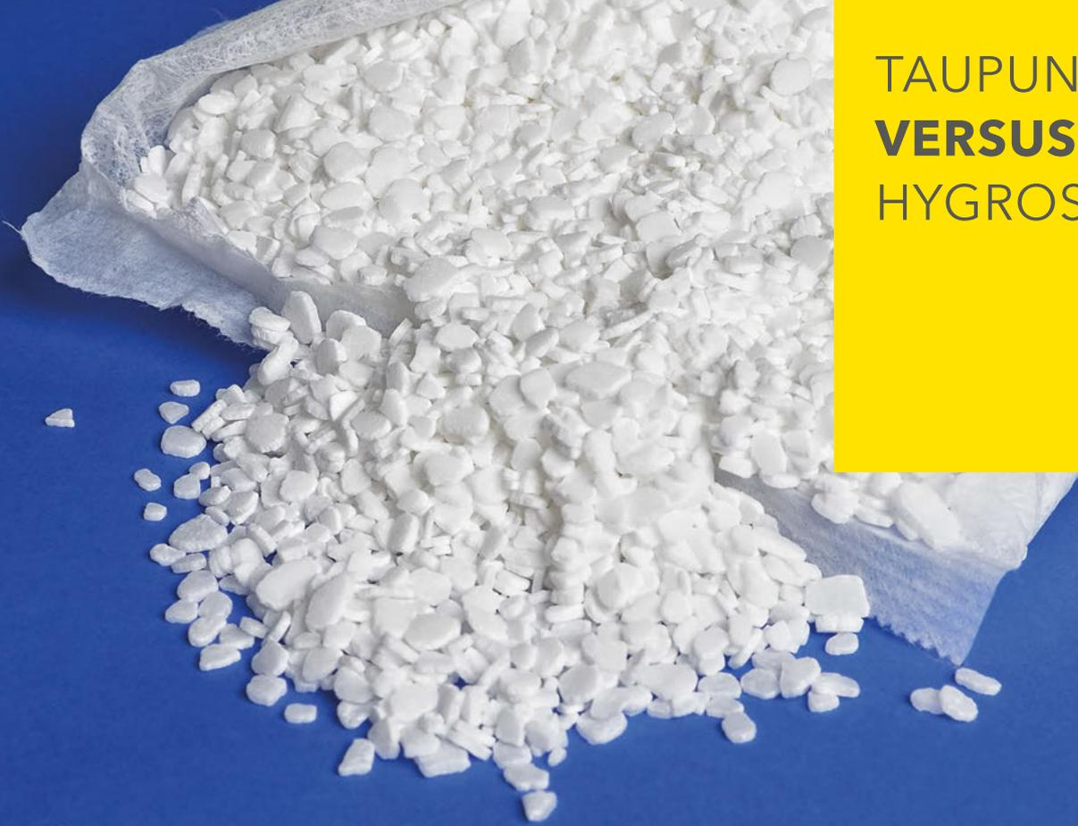
Die Abbildung oben zeigt den Inhalt eines typischen Nachfüllbeutels zur passiven Luftentfeuchtung per Granulat. Diese Einwegbeutel enthalten meistens stark hygroskopische Salze wie Calciumchlorid als Trocknungsmittel, welche der Raumluft durch Adsorption Feuchtigkeit entziehen können.
