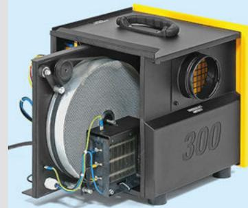
Die Abbildung oben zeigt das Innenleben mit Trocknungsrad des TTR 300 von Trotec. Dieser Industrie-Adsorptionsluftentfeuchter ist zwar sehr kompakt, aber ohne Wasserauffangbehälter dennoch nicht für typische Heimanwendungen geeignet.
