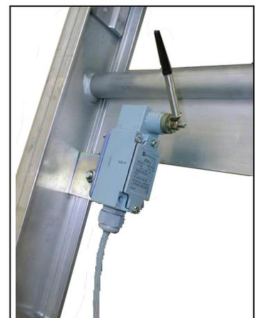
Fig. 42 Warteendschalter montieren
