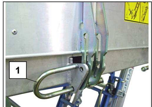
Fig. 20 Bordwandverriegelung offen
