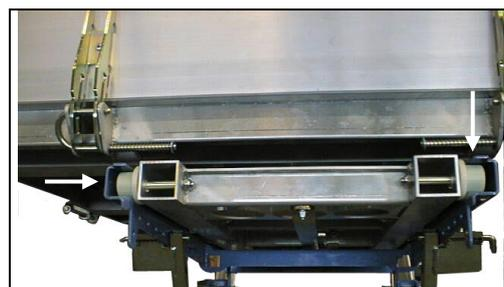
Fig. 48 Lastbühne montieren
