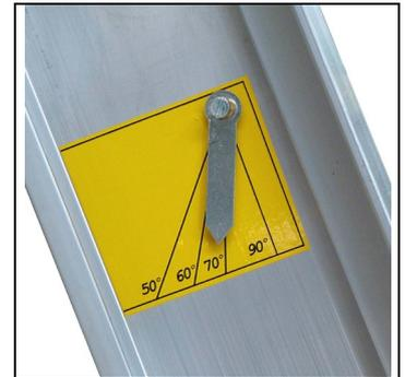
Fig. 32 Skala für den Neigungswinkel
