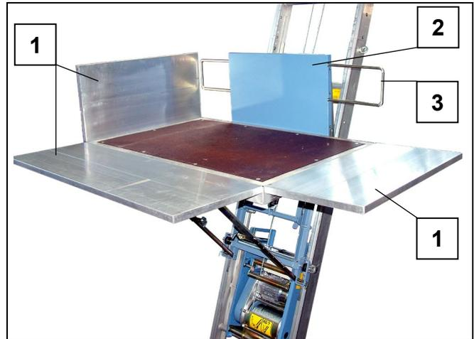
Fig. 51 Bordwände verstellen
