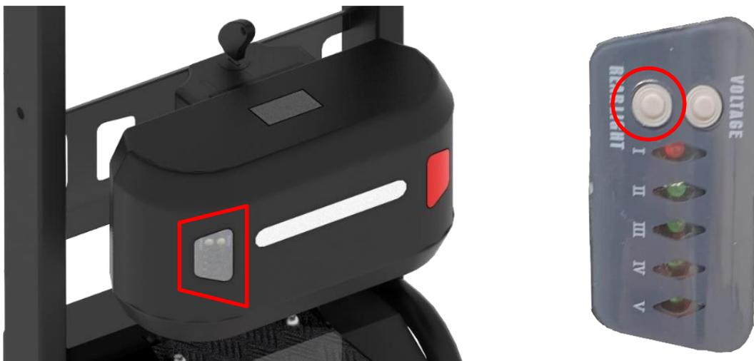
Um den Rückstrahler im Dauermodus einzuschalten, drücken Sie einmal auf die Taste Rückstrahler ein/aus. Um in den Blinkmodus zu wechseln, drücken Sie die Taste erneut. Um die Leuchte auszuschalten, drücken Sie erneut auf die Ein-/Ausschalttaste.
