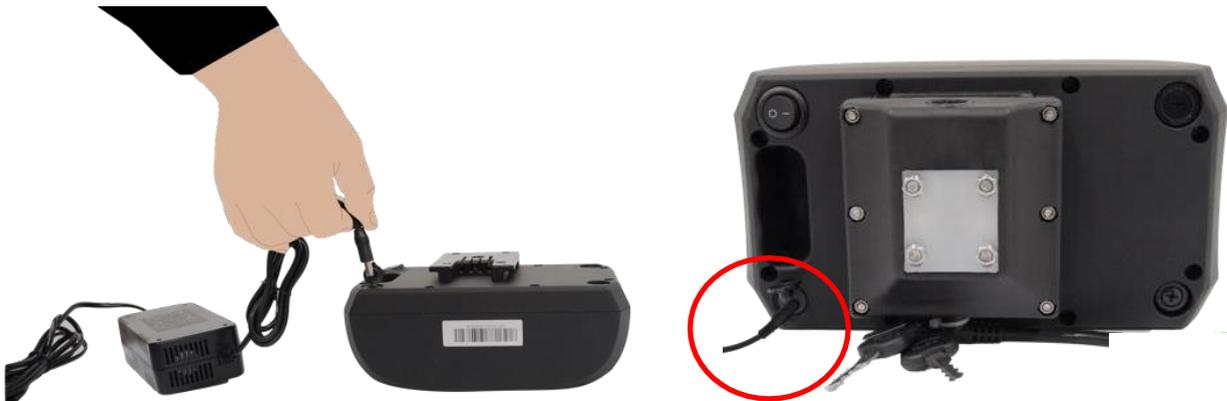
Um die Batterie zu laden, stecken Sie den Stecker des Ladegeräts in die Batterieladebuchse und den Stecker des Ladegeräts in die Steckdose.
