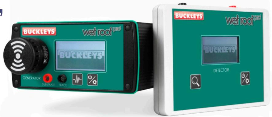
Das Set besteht aus zwei Hauptelementen, einer Generator- und einer Detektoreinheit. Die Generatoreinheit erzeugt über ein „Begrenzungskabel“, das um den Umfang des Testbereichs herum verlegt und an den Pluspol der Generatoreinheit angeschlossen wird, ein elektrisches Feld auf der Dachoberfläche. Der Minuspol ist mit einer geeigneten Erdung an der Gebäudestruktur verbunden.
