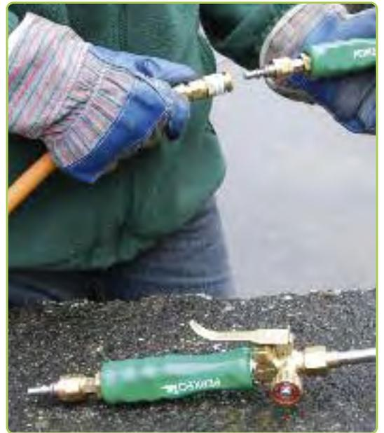
Einfach Brenner vom Gasschlauch auskuppeln und anderen Brenner ankuppeln – fertig!
