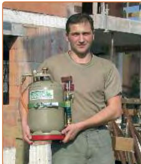
Der Inhalt der 5 kg-Propangasflasche reicht für über 40 Stunden Betriebszeit. Im Vergleich dazu reicht eine herkömmliche 0,425 kg-Kleinflaschen-Weichlötanlage nur 3,5 Stunden!
