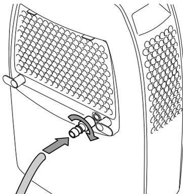
8. Führen Sie das andere Ende des Schlauches zu einem geeigneten Abfluss (z. B. Gully oder einem ausreichend großen Auffangbehälter). Beachten Sie, dass der Schlauch nicht geknickt werden darf.
