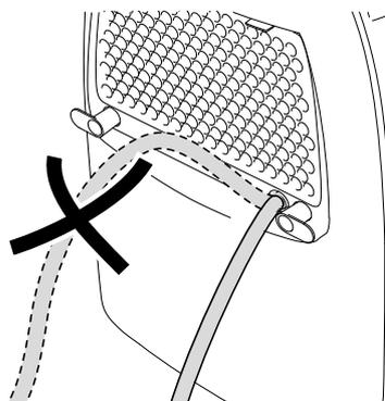
Entfernen Sie den Schlauch, wenn Sie das Kondensat wieder über den Kondensatbehälter auffangen wollen. Lassen Sie den Schlauch vor der Lagerung trocknen.
