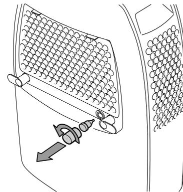
4. Setzen Sie den Gummistopfen auf den Ablauf im Inneren des Gerätes.
