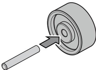
2. Kippen Sie das Gerät. Setzen Sie eine Transportrolle in die Aufnahmen an der Unterseite des Geräts, bis diese einrastet. Wiederholen Sie diesen Schritt für die restlichen 3 Transportrollen.
