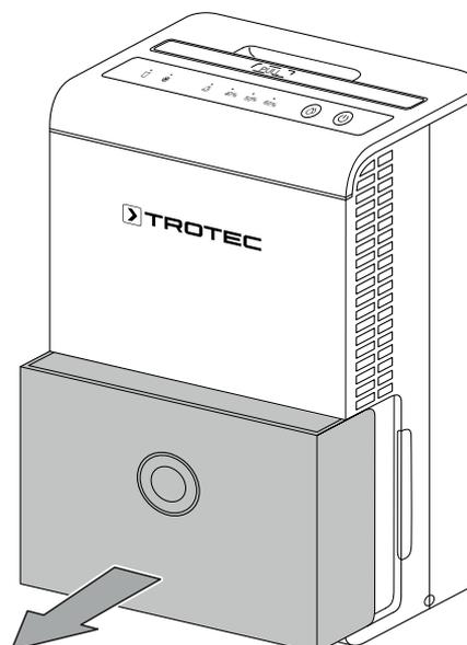
2. Entnehmen Sie die Luftfilter aus dem Gerät.
