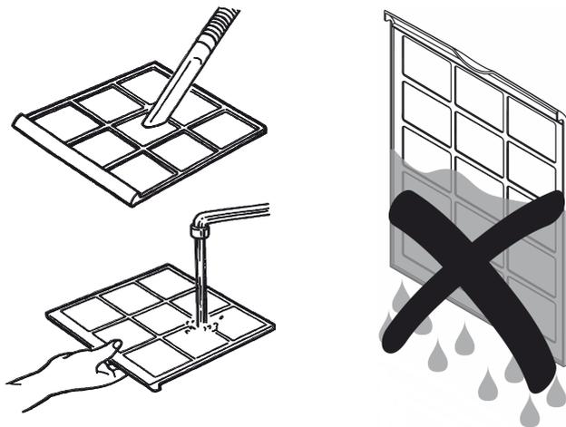
4. Lassen Sie die Filter komplett trocknen. Setzen Sie keine nassen Filter in das Gerät ein!
