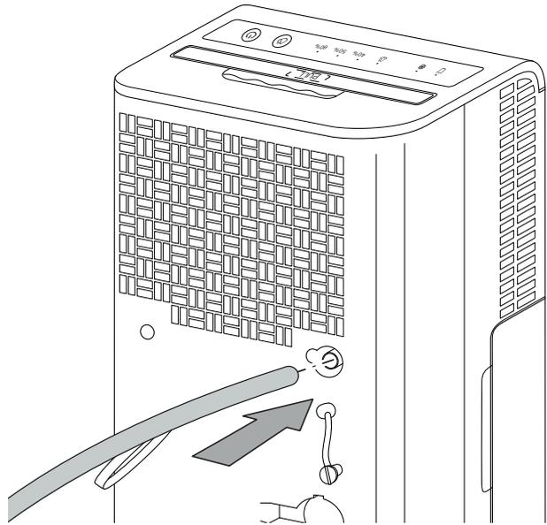
3. Führen Sie das andere Ende des Schlauches zu einem geeigneten Abfluss (z. B. Gully oder einem ausreichend großen Auffangbehälter). Beachten Sie, dass der Schlauch nicht geknickt werden darf.
