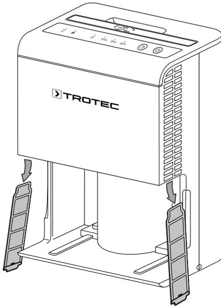
5. Setzen Sie die Luftfilter wieder in das Gerät ein.
