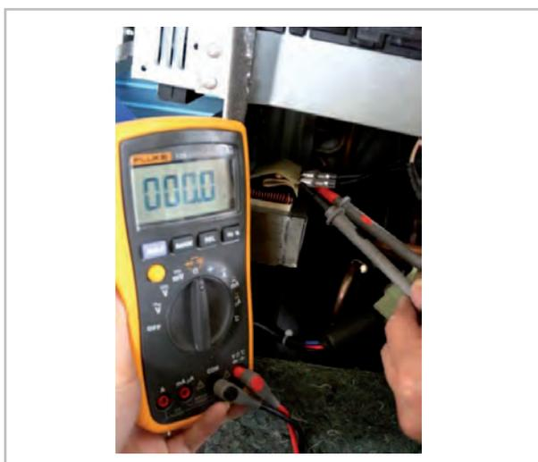
Abb. 43: Messung des Transformators
