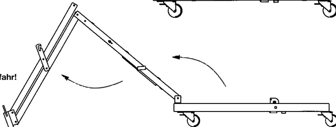
Der Kragarm sowie der Ständer werden ausgeklappt.
