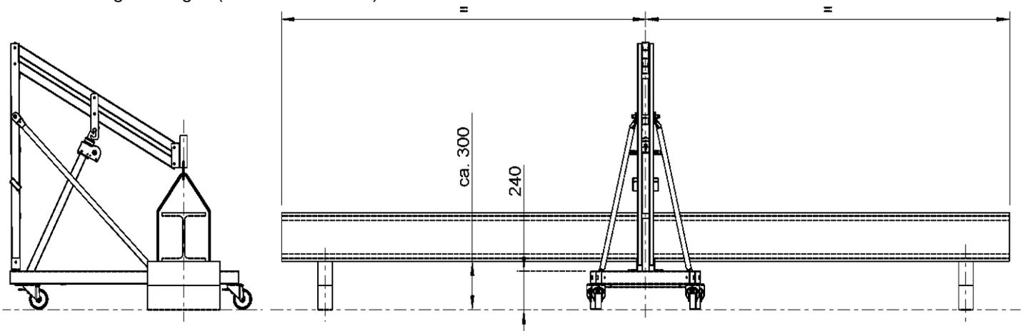
Nach Montage der Kopfgabel und gegebenenfalls des Adapters, ist der Träger (die Last) wiederum **MITTIG** im Schwerpunkt aufzunehmen. Bohrungen in der Platte der Kopfgabel ermöglichen eine zusätzliche Befestigung des Trägers. Während des Hubs empfiehlt es sich, die Unterstüzung stets nachzuführen und so für eine zusätzliche Kipp- und Fallsicherung zu sorgen. Der Kragarmlift darf mit aufgenommener Last ausschließlich in seiner Längsrichtung verfahren werden!
