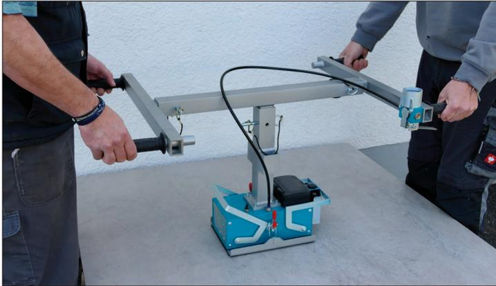
Alle glatten/rauen und luftundurchlässigen Platten können mit dem Beta-Levator problemlos gehoben, transportiert und verlegt werden. Sofort nach dem Aufsetzen saugt sich der Levator fest.
